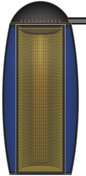
Abbildung 2.1: Design-Konzept des LENA-Detektors [15]. Der Flüssigszintillator befindet sich innerhalb des zentralen Zylinders, dessen Wände mit Photomultipliern (gelb) versehen sind. Das umgebende Myon-Veto ist in blau zu sehen.
