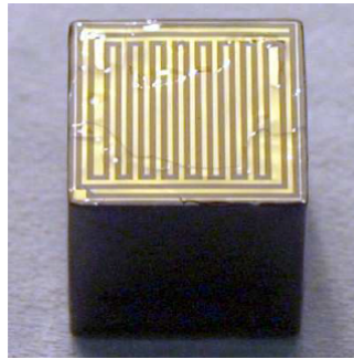
Abbildung 5: CPG-Detektor aus CdZnTe mit ineinander verschachtelten kammförmigen Anoden. [JEZ13b]
