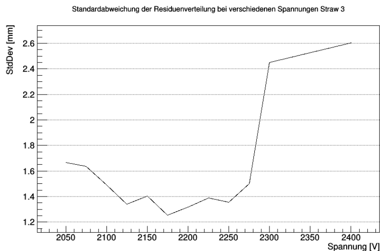
Abbildung 24: Auflösung der Strawtube 3 mit 45 \mu m-Draht bei verschiedenen Spannungen. Die zwei Messwerte für 2300 V und 2400 V haben deutlich schlechtere Auflösungen. Hier verursacht die hohe Spannung Störungen, welche zu vielen falsch positiven Signalen führen.
