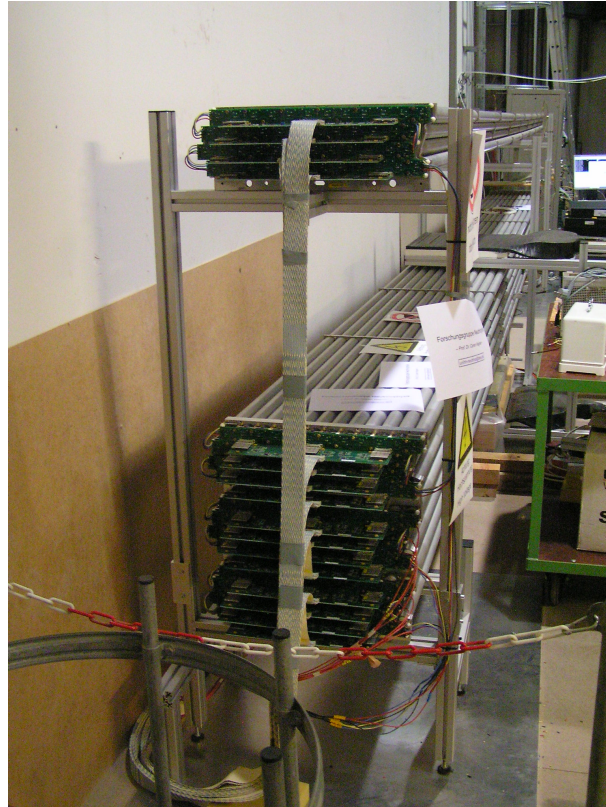
Abbildung 4.3: Foto der aufeinander liegenden Driftröhrenmodule. Zu erkennen ist die identische Ausrichtung aller vier Module. Ansicht auf die Endplatten der Module mit Versorgungsplatinen und Vorverstärkern.
