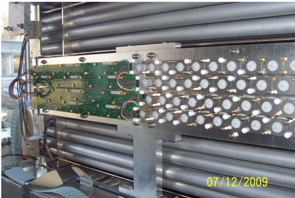
Abbildung 5.2: Beim Modul links im Bild sind die HV-Boards schon montiert und angeschlossen, beim rechten Modul sieht man noch die blanken Drähte aus den weissen Plastikkappen ragen.
