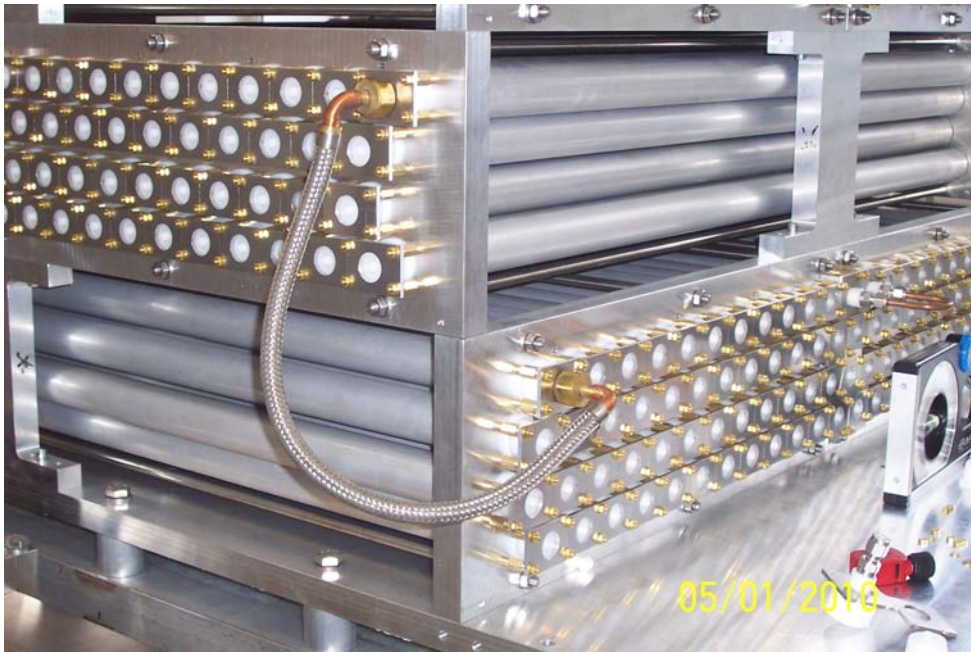
Abbildung 5.4: Die Röhren eines Moduls sind durch Löcher in den Lochblenden verbunden. Damit die Gasmischung in den gesamten Detektor gelangt, sind zwei Module einer Ebene durch ein Kupfer-U-Rohr (rechts im Bild) verbunden, die Module verschiedener Ebenen durch einen Schlauch auf den Ecken (Bildmitte).
