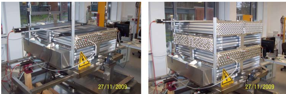
Abbildung 5.1: Der Detektor vor (links) und nach (rechts) dem Ausbau von vier auf acht Module. Bevor die neuen Module auf die alten gehoben werden konnten, musste der Szintillator herunter genommen werden. Während die HV- und Preamplifierboards bei den unteren Modulen schon durch einen Aluminiumkasten gesichert sind, sind diese bei den oberen Modulen noch gar nicht angebracht.
