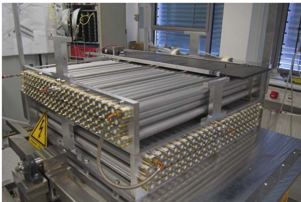
Abbildung 4.1: Der sensitive Teil des Detektors. Hier zu erkennen sind die vier Module und der obere Szintillator
