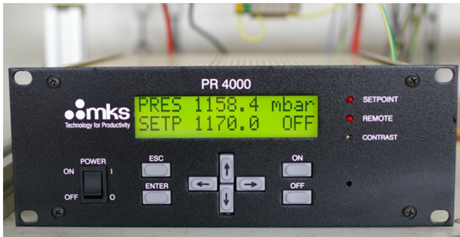
Abbildung 6.5: Einkanal-Betriebsgerät PR 4000 S. PRES gibt den aktuellen Druck in mbar an, SETP den eingestellten Druck, auf den das Gerät regeln soll.
