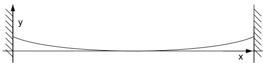
Abbildung D.2: Das Seil ist an den Seiten fest, hängt aber durch sein Eigengewicht durch.
