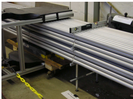
Abbildung 5.17: Der große Teststand. Zu sehen ist die Höheneinstellung in der Mitte der Module. Eine Wasserwaage dient zur Kontrolle, dass die Höheneinstellung über zwei Gewinde (unten) gleichmäßig erfolgt. Abgelesen wird die Höhe über einen Höhenanreißer (hinten). Links sieht man die beiden Szintillatoren, die den Trigger geben.
