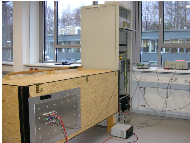
Abbildung 4.1: Der Teststand: Im Vordergrund ist die Dunkelkammer zu sehen, im Hintergrund die Messelektronik.
