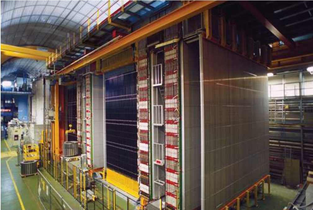
Abbildung 4.5: Fotografie des OPERA-Detektors kurz nach der endgültigen Fertigstellung: Im vorderen Bereich sind die beiden letzten PT-Wände gut zu erkennen, daran anschließend folgt der Magnet des zweiten Supermoduls sowie der Targetbereich (schwarz). Die Plattform auf dem Detektor, die durch gelb-rote Geländer gesichert ist, bietet Platz für die Elektronik aller Detektorkomponenten. Im hinteren Bereich der Halle ist das Experiment Borexino zu sehen (Foto: M. Chabior).
