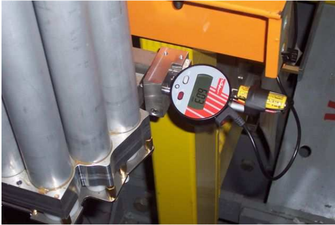
Abbildung 7.3: Fotografie einer Messuhr des Positionsüberwachungssystems, die unten an der Seite einer PT-Wand positioniert ist und die zeitlichen Änderungen der Positionen digital protokolliert (Foto: H.-J. Ohmacht).
