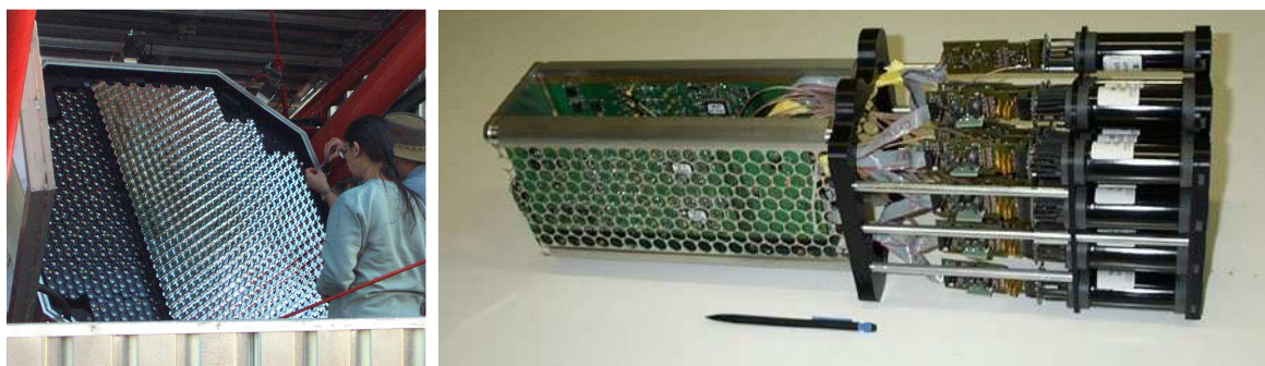
Abbildung 3.6: Links: Technische Arbeiten an der geöffneten Kamera des Teleskops CT03. Zu erkennen ist die aus 960 Bildpunkten bestehende Photomultiplier-Matrix, sowie die davor angebrachte Struktur der Lichtsammeltrichter, die im Moment der Aufnahme nur auf der rechten Hälfte der Kamera montiert ist. Rechts: Ein einzelner Drawer , bestehend aus 16 Photomultipliern (rechte Seite des Drawers ) und der Elektronik zur Hochspannungsversorgung, Signal-Auslese und Digitalisierung (linke Seite). Zum Größenvergleich ist unten ein Kugelschreiber abgebildet.
